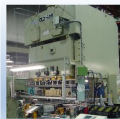
160 mm 10工程トランスファー装置付きプレス
